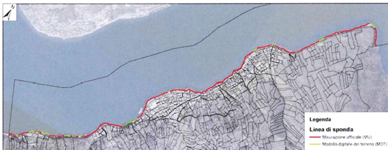
Figura 3 – Linea di sponda definita sulla base dei confini catastali della MU (in rosso) e secondo il modello digitale del terreno per la quota di riferimento di 271 m s.l.m. (in verde) – Fonte Oikos.
